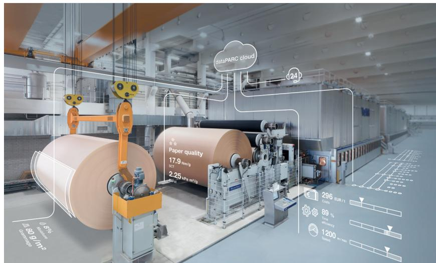
O *OnEfficiency.Strength* é um dos módulos do MillOne, plataforma da Voith que visa acelerar a digitalização e transformar as indústrias em fábricas autônomas. A solução combina sensores virtuais, controle preditivo e otimização de custos para garantir qualidade e eficiência em tempo real.
