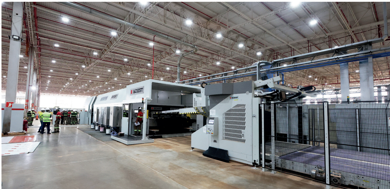
As impressoras corte e vinco foram fornecidas pela BOBST e têm capacidade para impressão de até quatro cores, sendo que uma delas oferece a possibilidade de imprimir até duas cores na parte interna, totalizando seis cores à embalagem
