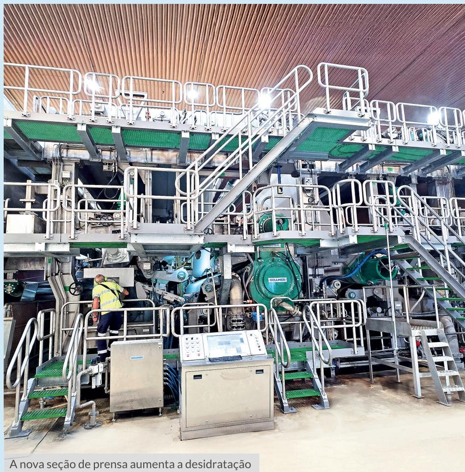
A nova seção de prensa aumenta a desidratação
