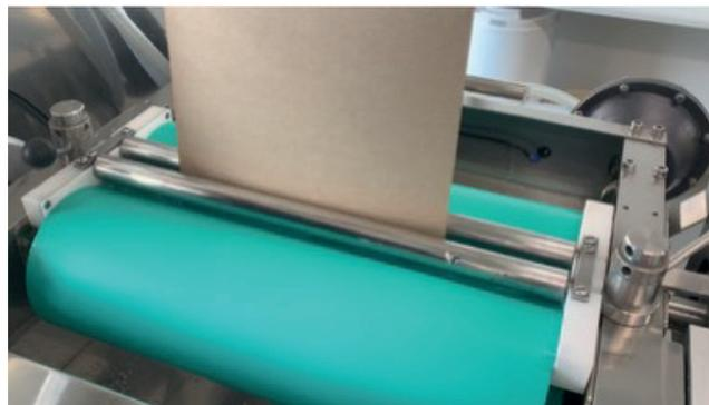
Figura 2. Aplicadora Foulard laboratório
