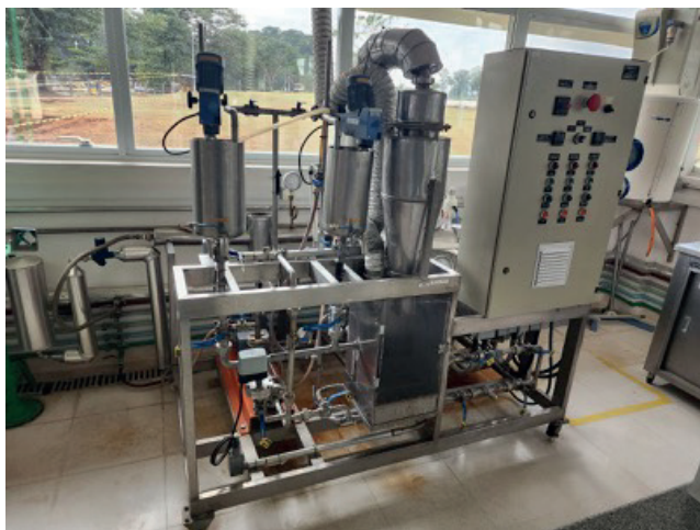
Figura 1. Reator piloto (direita) e sistema jet cooker (esquerda) utilizados para síntese do produto Kofilm 400
