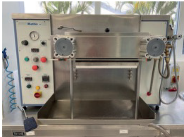
Figura 3. Equipamento size press utilizado para aplicação superficial do produto Kofilm 400 em amostra de papel, dando destaque para os rolos de aplicação de produto (direita)
