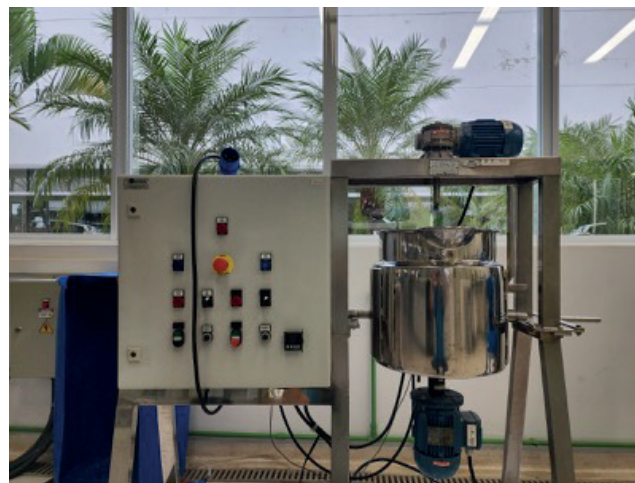
Figura 1. Reator piloto (direita) e sistema jet cooker (esquerda) utilizados para síntese do produto Kofilm 400
