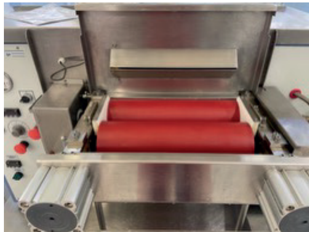
Figura 3. Equipamento size press utilizado para aplicação superficial do produto Kofilm 400 em amostra de papel, dando destaque para os rolos de aplicação de produto (direita)
