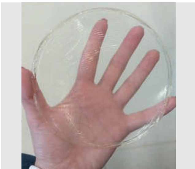
Figura 5. Filme obtido por meio do método de casting para o Kofilm 400
