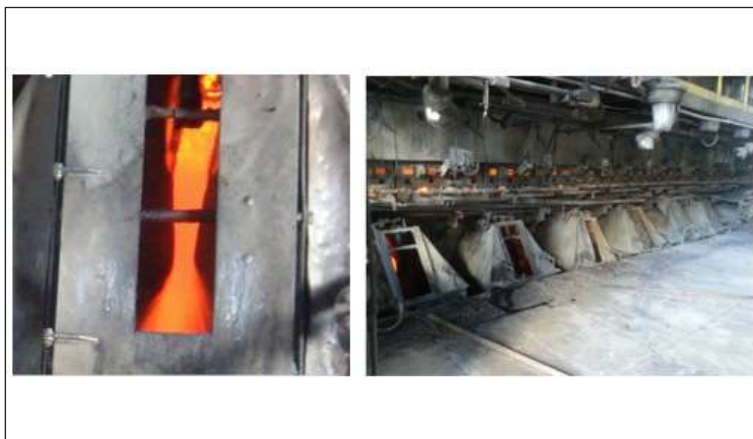
Figura 6. (A) - Bica de Smelt / (B) - Conjunto de bicas na caldeira de recuperação
