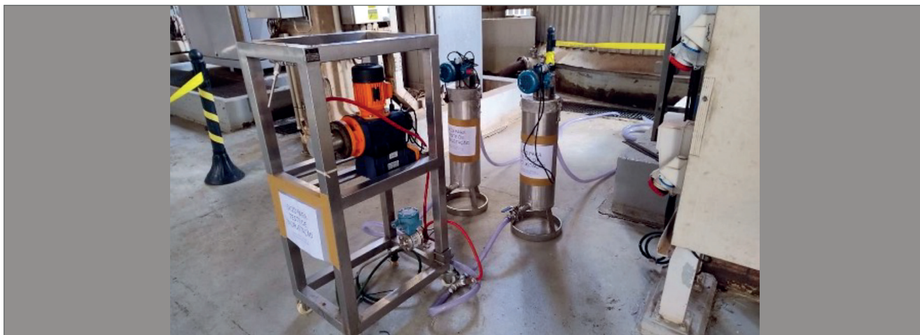
Figura 1. Dispositivo para avaliação de deposição no processo produtivo
