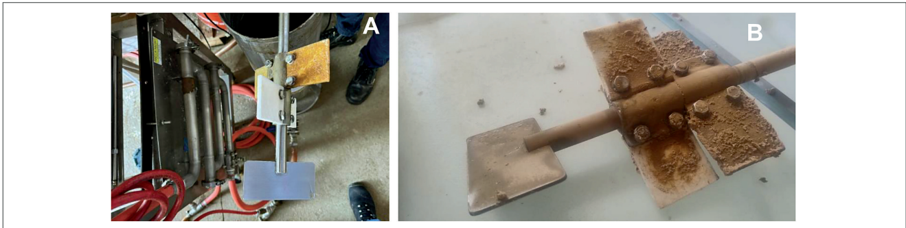
Figura 14. Corpo de prova do dispositivo com formação de oxalato
