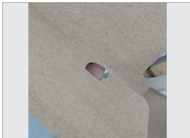
Figura 9. Teste de celulose reciclada não branqueada no Verso, mostrando boa performance em corte e vinco Fonte: próprio autor
