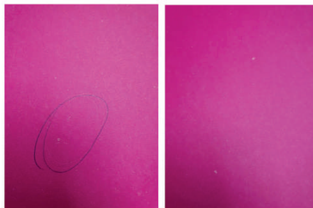
Figura 6. Impressão de Verso apresentando falhas de impressão devido soltura de pó no teste de celulose reciclada branqueada
