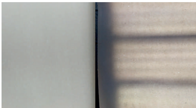
Figura 7. Apresentação do Verso de celulose reciclada branqueada, mostrando pequenos furos na formação Fonte: próprio autor
