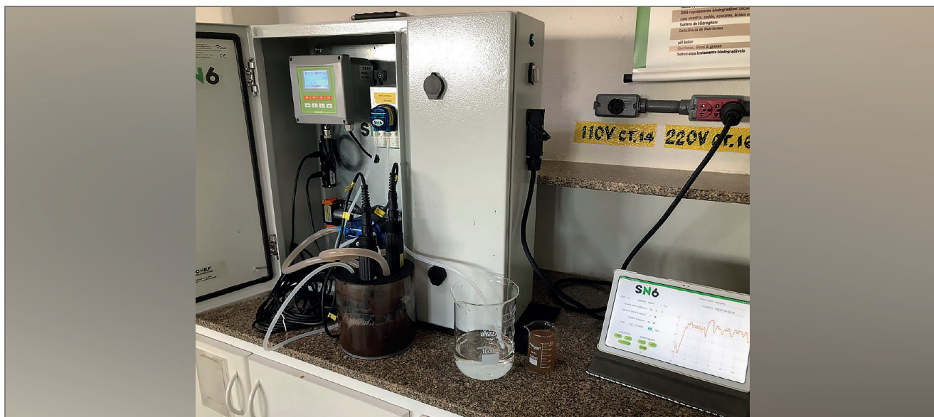
Figura 2. Respirômetro SN6 realizando ensaio de toxicidade
